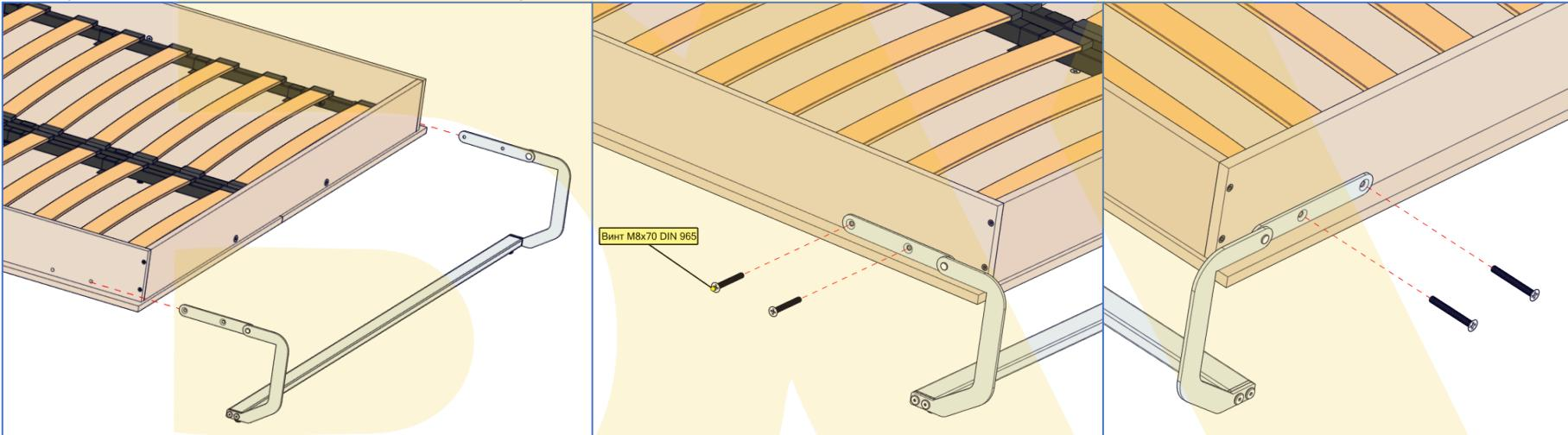
С обратной стороны на винт навинчивается гайка самоконтрящаяся
