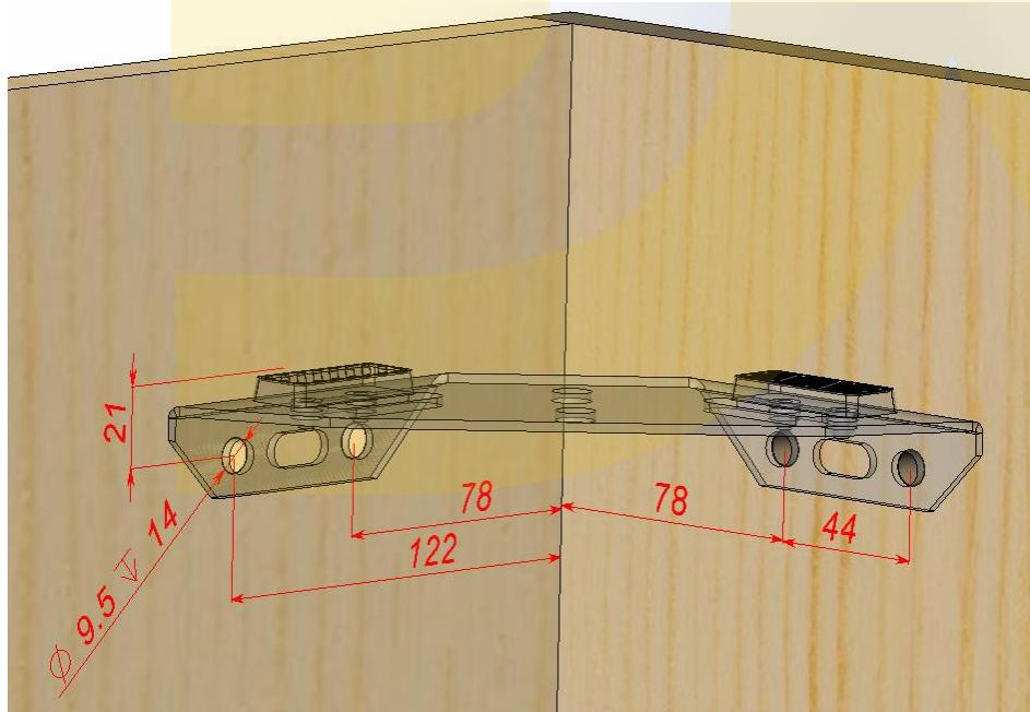
б) монтаж стяжки осуществляется в предварительно высверленные глухие отверстия диаметром 9,5 глубиной 14мм. Фиксирующими элементами служат Футорка M8x13 и Винт мебельный M8x16. Фиксация выполняется в четырех крепежных точках.
