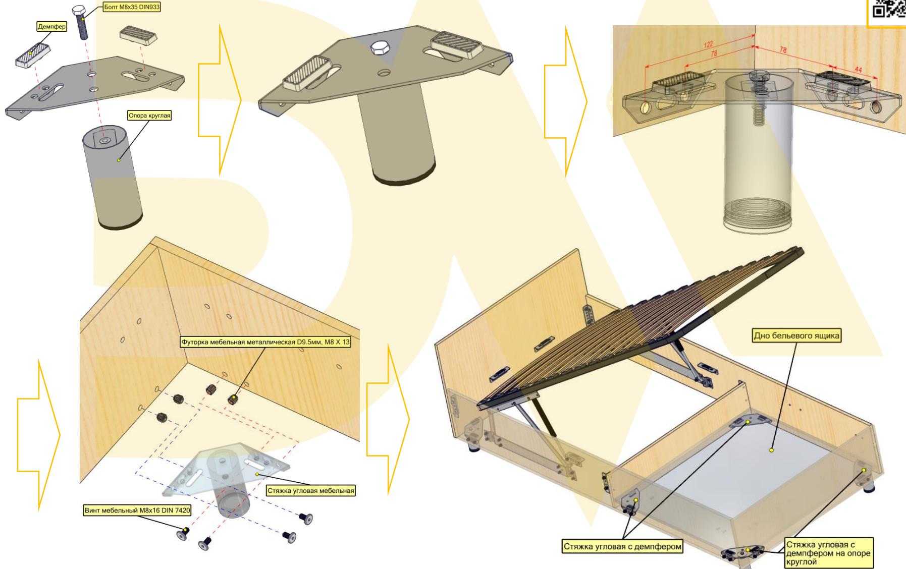
в) в случае использования полки в качестве углового соединителя монтаж осуществляется в предварительно высверленные глухие отверстия диаметром 9,5 глубиной 14мм. Фиксирующими элементами служат Футорка M8x13 и Винт мебельный M8x16. Фиксация выполняется в четырех крепежных точках.
