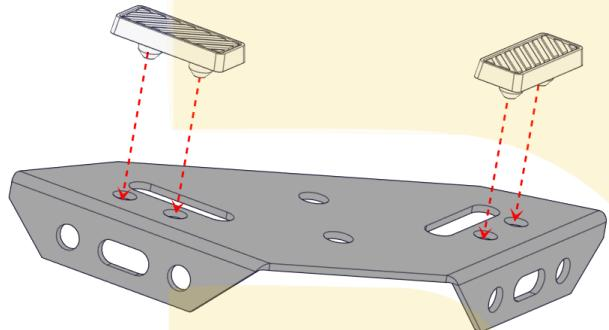
а) Установка демпфирующих элементов производится в специальные отверстия.
