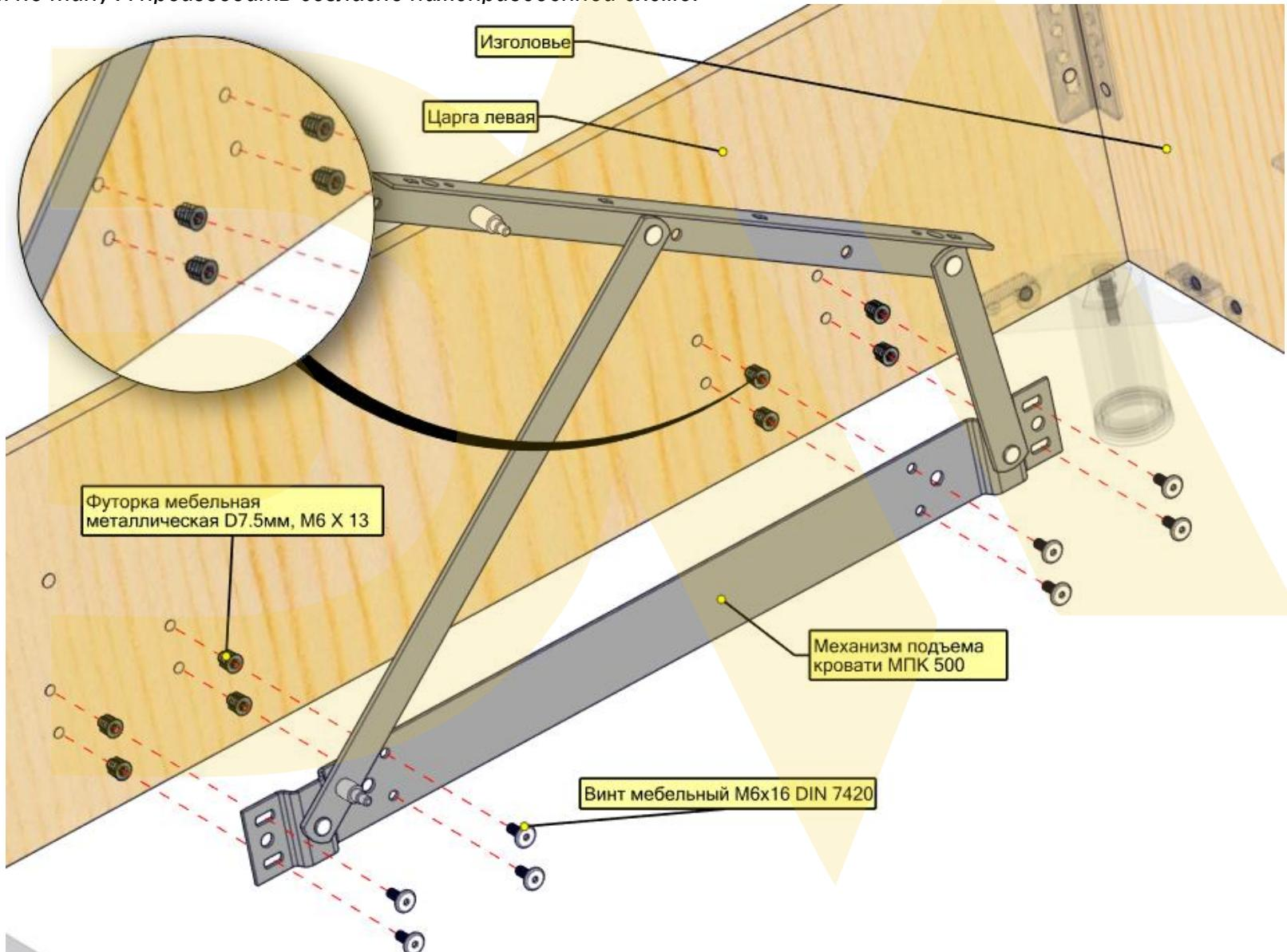
Фиксирующими элементами служат Фурнитура M6x13 и Винт мебельный M6x16.
