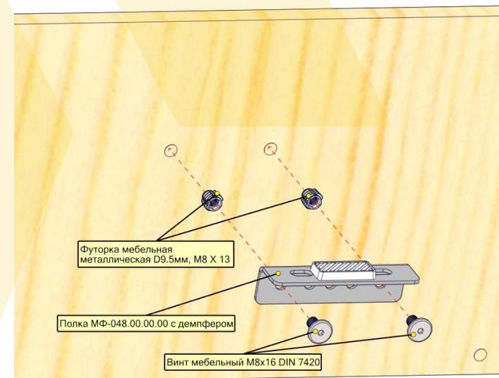
Полка опора так же может быть использована в качестве углового соединителя элементов конструкции кровати.
