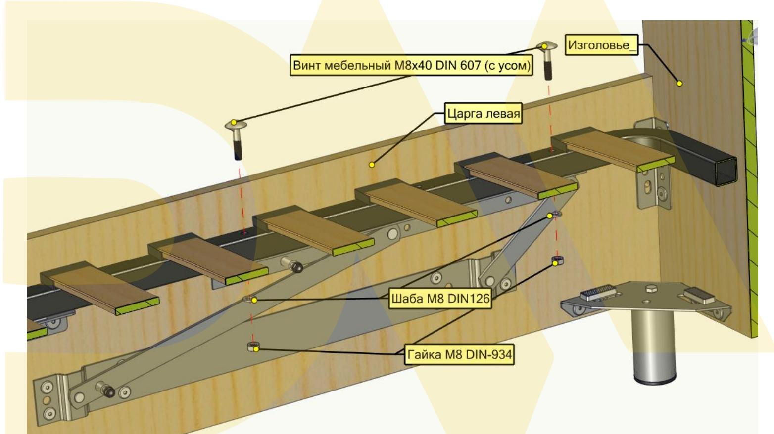
Фиксирующими элементами кроватного основания служат Винт мебельный M8x40 DIN607 (устанавливается сверху) и гайка M8 DIN934 с шайбой M8 DIN126.
