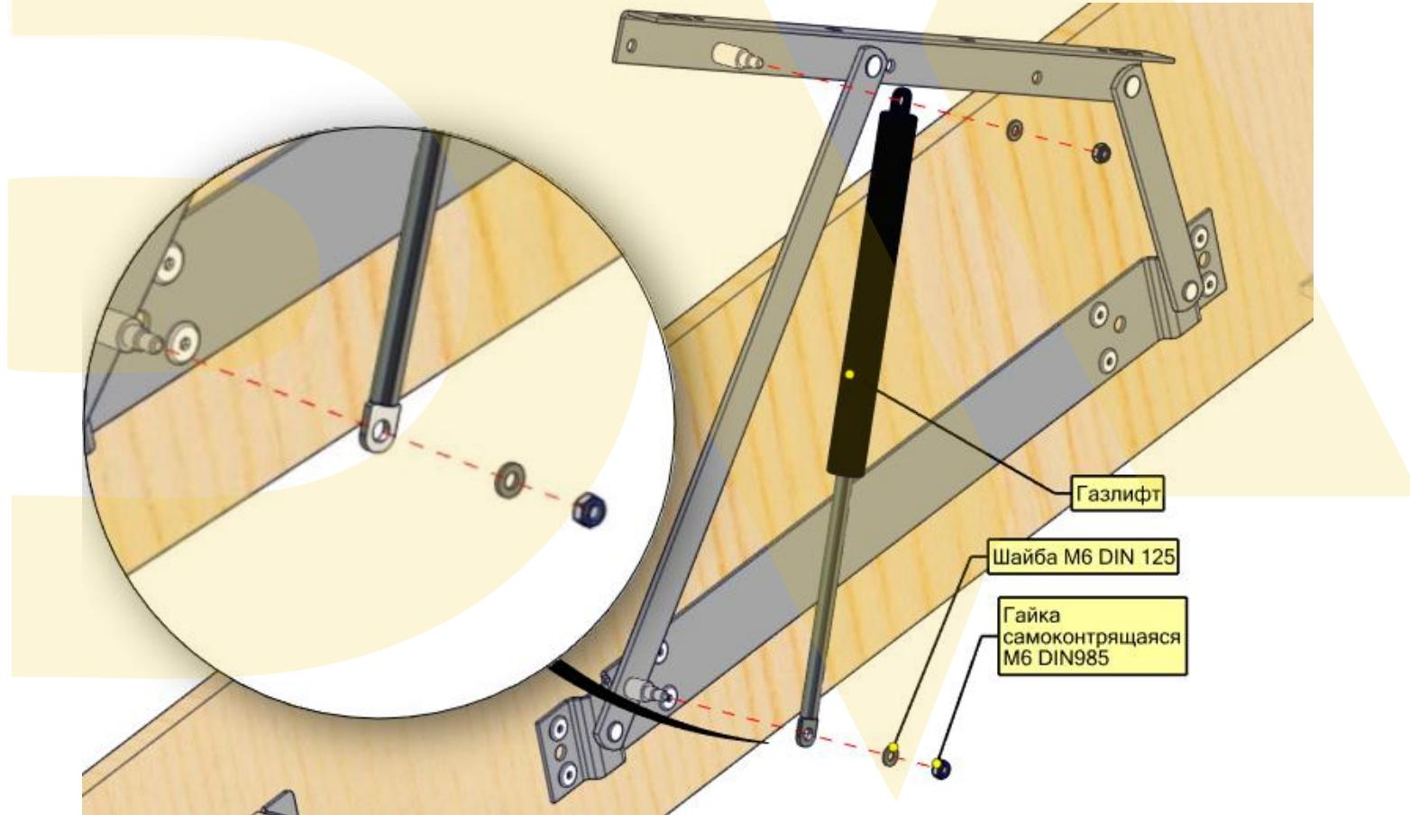
Фиксирующими элементами газлифта являются шайба M6 DIN125 с гайкой M6 DIN985.
