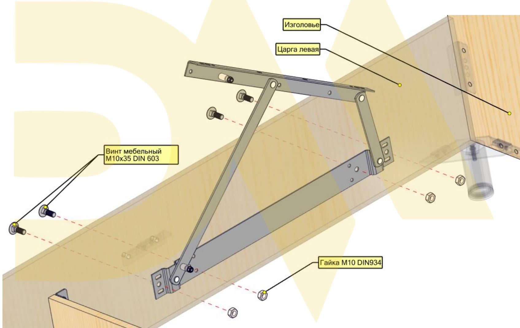
Фиксирующими элементами Винт мебельный M10x35 DIN603 и гайка M10 DIN934.
