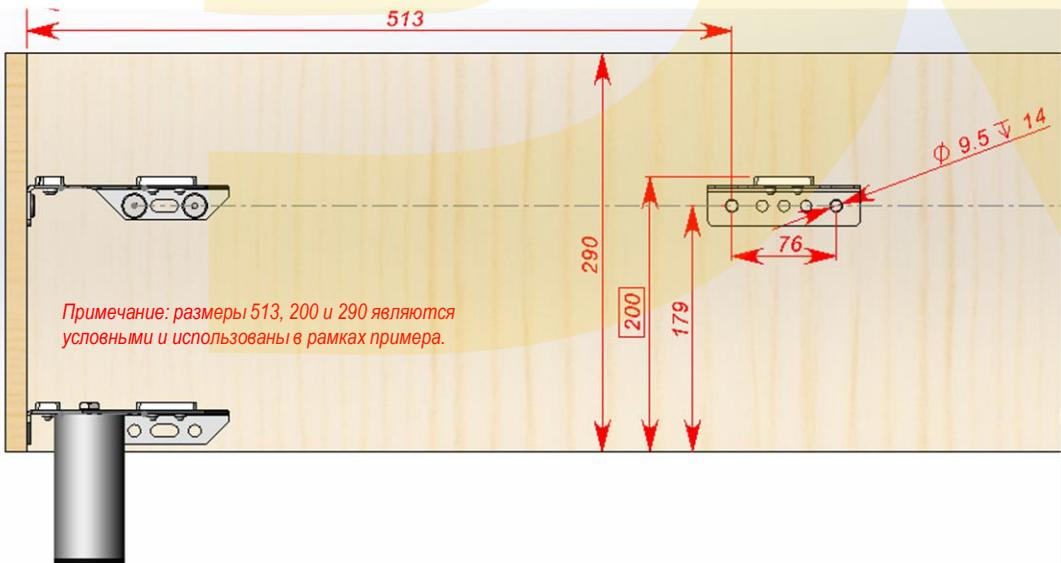
б) монтаж полки осуществляется в предварительно высверленные глухие отверстия диаметром 9,5 глубиной 14мм.
