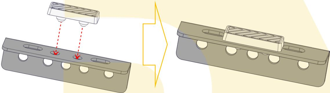
а) Установка демпфирующего элемента производится в специальные отверстия.
